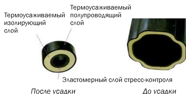
Рис. 1. Трёхслойная трубка с внутренним эластомерным слоем стресс-контроля
